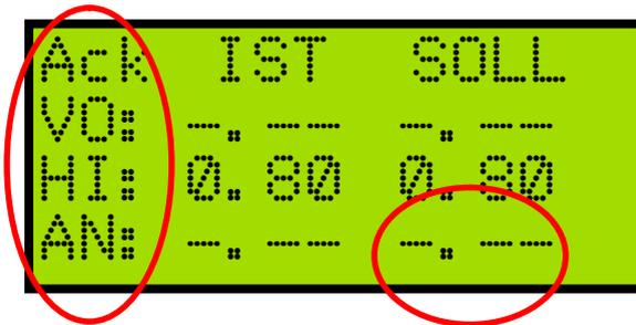
Nicht angeschlossene Achsen werden mit (-.-) angezeigt. Angeschlossene Achsen zeigen in der linken Spalte, unter (**IST**), den aktuellen Reifendruck in bar an. In der rechten Spalte wird unter (**SOLL**) der Solldruck angezeigt.
