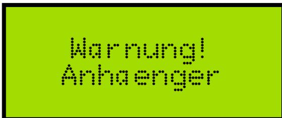
Sollte die Warnung beim Einschalten jedoch nicht aufhören, sind die Kugelhähne an den Felgen noch geschlossen oder der Luftdruck in den Reifen liegt über oder unter dem eingestellten Grenzwert. In diesem Fall sollten Sie das überprüfen.
