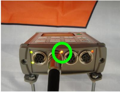
LED Mitte rot zeigt die Funktion ‚Befüllen‘ an.
