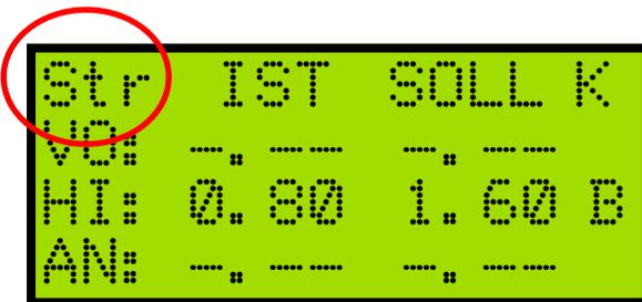
Wenn sie die Taste Straße (8) drücken, gelangen sie in den Straßenmodus. Auch dies wird mit einem Piepton bestätigt. Oben links in der Anzeige ist dann (**Str**) zu sehen erhielt. Es wird der Solldruck, der im letzten Straßenmodus gefahren wurde, automatisch eingestellt.
