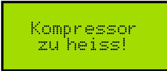
Der Kompressor wird somit vor Überhitzung geschützt. Sobald der Kompressor wieder abgekühlt ist, schaltet die Steuerung den Kompressor wieder automatisch ein.
