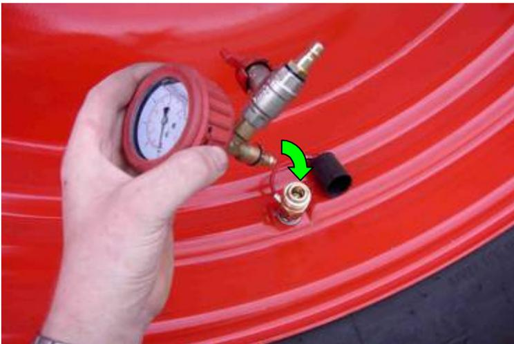
Der Reifendruck ist nur abzulesen, wenn der Kugelhahn geschlossen ist. Zum Ablassen öffnen Sie nun den Kugelhahn, die Luft entweicht und der Zeiger im Manometer fällt auf **0 bar**. Schließen Sie den Kugelhahn nach einiger Zeit wieder. Das Manometer zeigt nun den derzeitigen Reifenluftdruck an.
