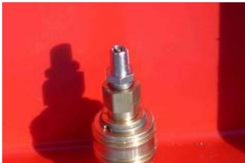
Diesen Adapter drücken Sie einfach in den Schnellkuppler auf dem Reifenventil und Sie haben nun wieder einen Standard-reifenventilanschluss, ohne das Sie die Schnellkuppler demontieren müssen.
