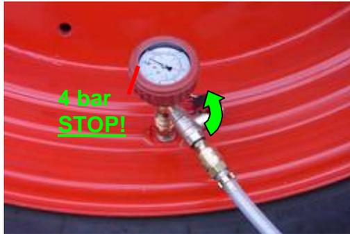
Haben Sie den gewünschten Reifendruck eingestellt, lösen Sie die Kupplungen, stecken die Staubschutzkappen auf und wickeln den Druckluftschlauch möglichst klein auf. Anschließend finden wieder alle Teile Platz im Koffer.
