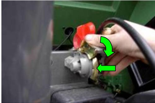
Entfernen Sie die Staubschutzkappe und drücken Sie den Druckluftschlauch in den Schnellkuppler am Kupplungskopf.
