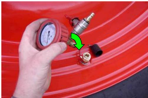
Drücken Sie jetzt die Schnellkupplung des Druckluftschlauches auf die offene Anschlussstülle am Kugelhahn, nicht am Manometer.
