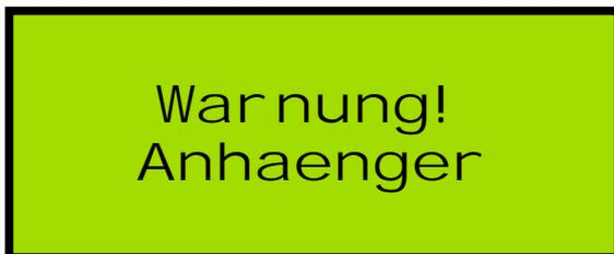
Sollte die Warnung beim Einschalten jedoch nicht aufhören, sind die Kugelhähne an den Felgen noch geschlossen oder der Luftdruck in den Reifen liegt über oder unter dem eingestellten Grenzwert. In diesem Fall sollten Sie das überprüfen.
