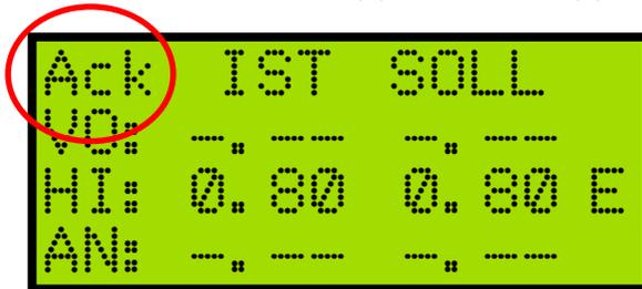
Wenn sie die Taste Acker (7) drückten, gelangen sie in den Ackermodus. Das wird durch einen Piepton bestätigt und oben links in der Anzeige wird (**Ack**) angezeigt. Es wird der Solldruck, der im letzten Ackermodus gefahren wurde, automatisch eingestellt.
