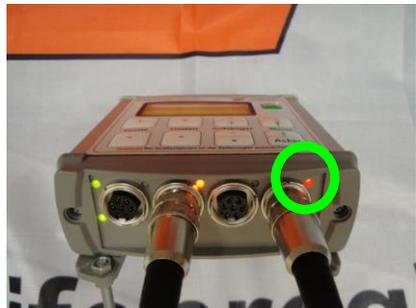
LED oben rechts rot: Temperaturschalter des Kompressors ausgelöst! Temperatursensor defekt oder Kompressorkabel beschädigt!
