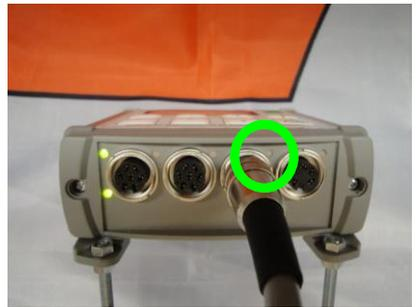
LED oben Mitte aus: Druck erreicht; keine Funktion wird ausgeführt.
