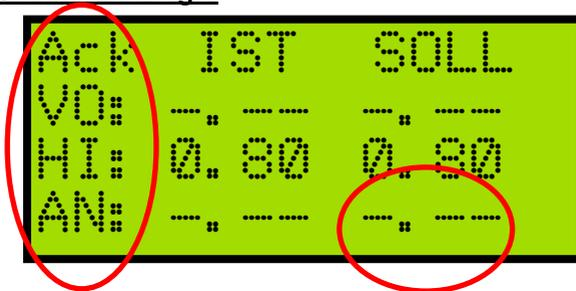
Nicht angeschlossene Achsen werden mit (-.-) angezeigt. Angeschlossene Achsen zeigen in der linken Spalte, unter (IST), den aktuellen Reifendruck in bar an. In der Rechten Spalte wird unter (SOLL) der Solldruck angezeigt.
