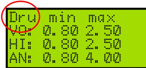
Hier wird der Druckbereich eingestellt, als niedrigster und höchster Wert. Das ist nicht der Wert für Acker oder Straße. Es wird nur der Bereich vorgegeben, in dem Sie später den Solldruck einstellen können. Des Weiteren hat der Mindestwert noch eine weitere Bedeutung, auf die später noch genauer eingegangen wird.
